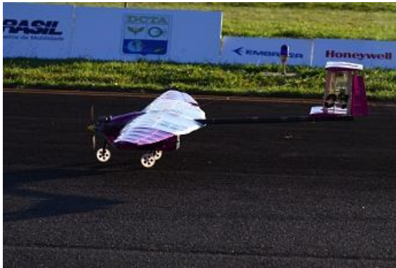
Figura 3 – Aeronave TKV 2009 com Trem de pouso em configuração triciclo fixo.
